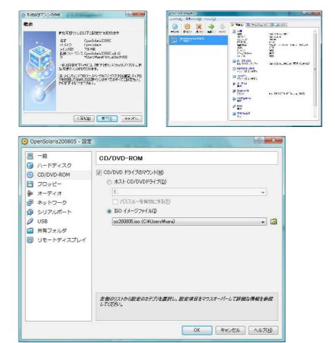
CD/DVD ドライブのマウントと ISO イメージファイルをチェックします。イメージファイルには、ダウンロードして保管した、os200805. iso ファイルを指定します。
