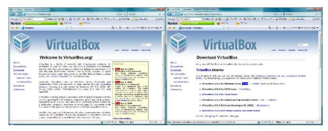
Windows 上で使用するには、「VirtualBox x.x.x for Windows host [x86] 」を選択します。[AMD 64] 版は、Windows x64 (64bit 版) 用になります。ダウンロードした、実行形式のファイル(.msi ファイル) を実行すると、インストーラーが起動されます。
